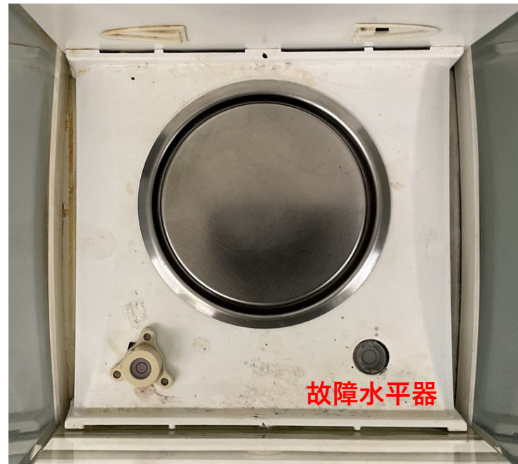
【装置塗装不良および汚れ】
