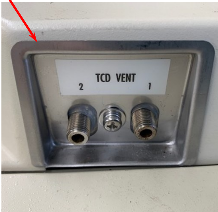
【検出器ガス排出部】
